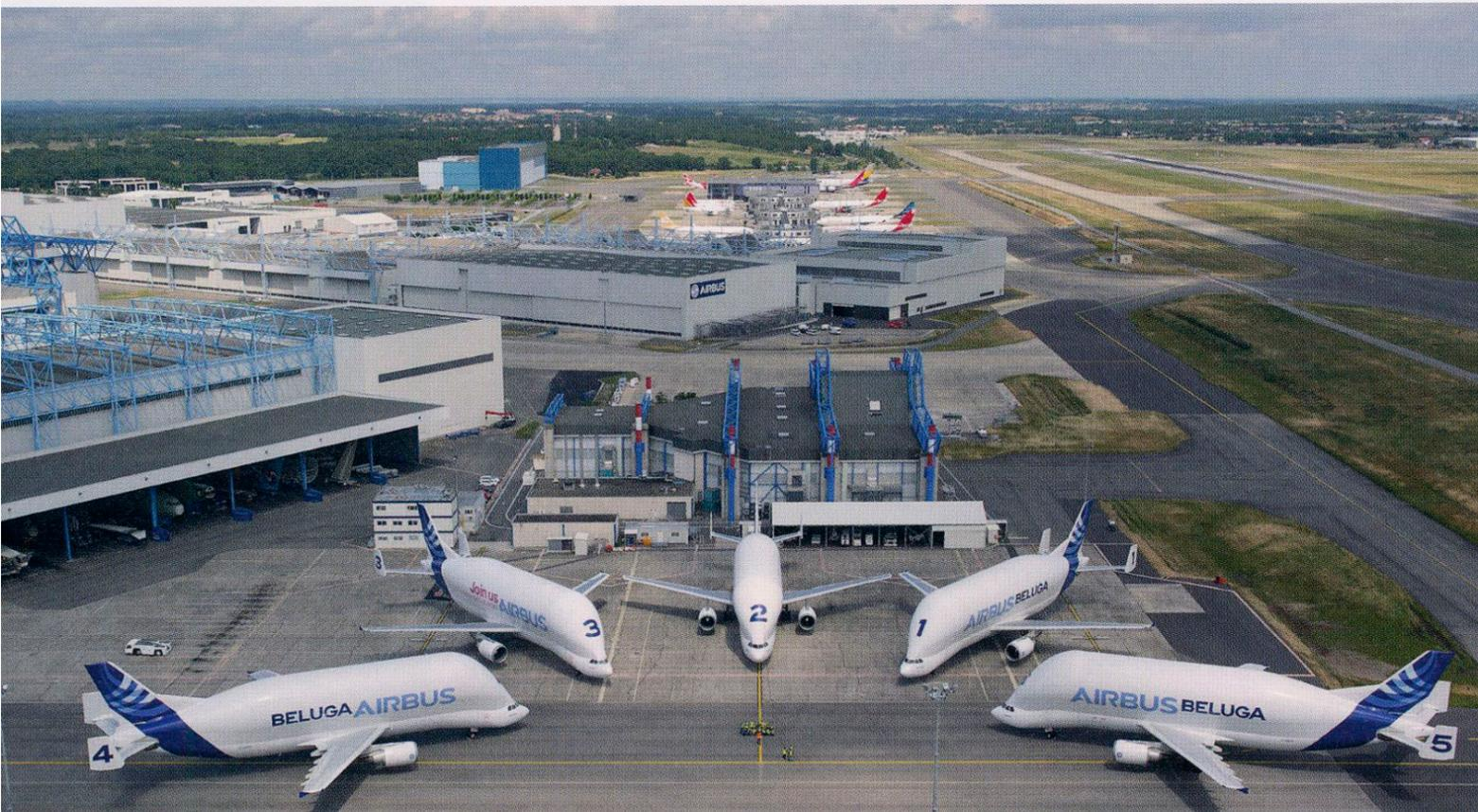
A319 transportieren zu können. Aufgrund des hohen Rumpfes und der damit verbundenen geringeren Anströmung des Leitwerks wurde dieses vergrößert und erhielt zusätzlich Endplatten.
