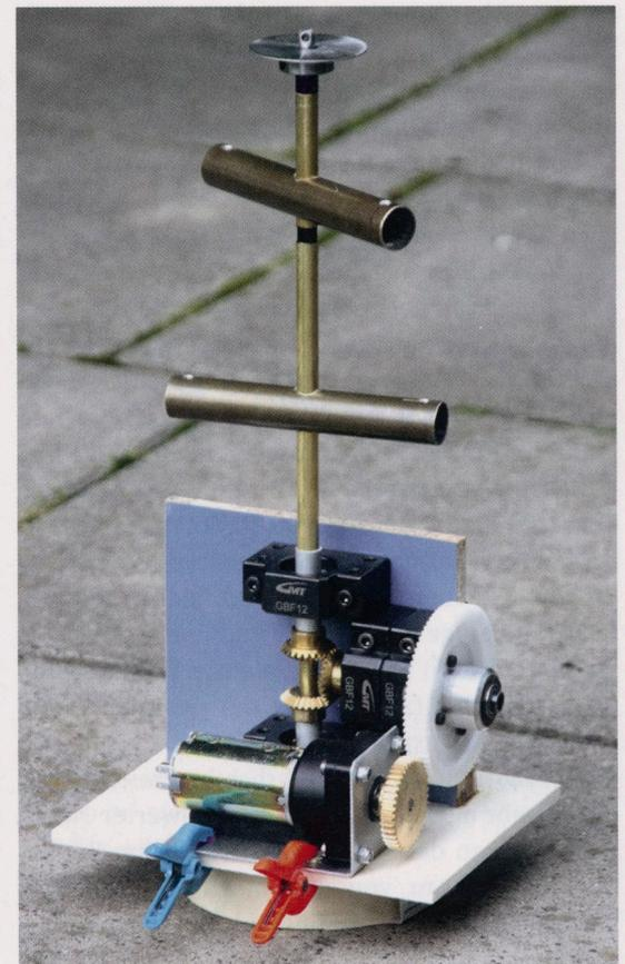
Die zusammengeschaubte »Zahnrad-Versammlung« mit Mast und Solarauflage zeigt, dass alles in dieser Form funktioniert und auch in den Kasten des Ingenuity – wie gedacht – hineinpasst.
