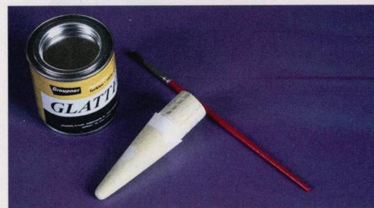
Wozu ein alter Besenstiel-Rest doch gut ist! Mit etwas Autospachtel aufgepeppt – und ab in die Drehbank! Zwecks Abformung in Silikon. Denn auch der kleine Ingenuity-Hubschrauber ist mit helfenden »Chinese Weights« (PMGs) an den Rotoren ausgerüstet.
