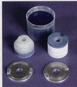
Teile der beiden Stator-Taumelscheiben aus Alu, die jedoch als Korrektur noch mit drei Anlenk-Kugeln versehen werden. Dazu die rotierenden Oberteile aus Epoxidharz-Resten, die sich »butterweich« drehen und bearbeiten lassen.
