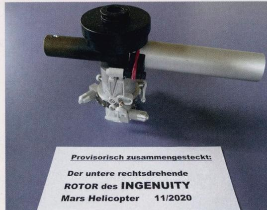
Der untere, rechtsdrehende Rotor des Ingenuity ist schon mal zur Kontrolle versuchsweise zusammengesteckt worden.
