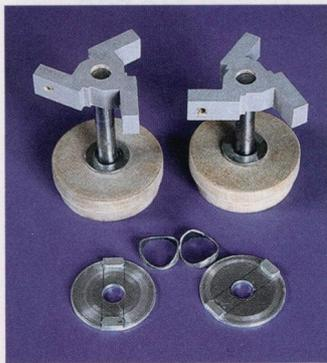
Die beiden (noch schwarz zu spritzenden) Attrappen der Antriebsmotoren mit den Zentralstücken für die (je drei) E-Stellmotoren der NASA, die für die zyklische und kollektive Steuerung der Rotoren zuständig sind.
