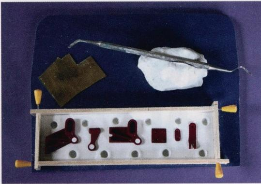
Keineswegs aus dem 3D-Drucker entsprungen, sondern einfach handgefertigt: Zwei unterschiedliche DFC-Ansteuerungen (à la Align) für die Taumelscheiben. Bestehend aus Messingblech, kombiniert mit gut zu bearbeitendem Auto-Feinspachtel. Die erste Formhälfte aus Silikon kann gegossen werden.
