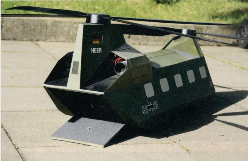
Bei der Gliederung und Konstruktion der Heckklappe ist hier ein wenig »Sikorsky CH-53« hineingedacht worden, indem das Oberteil nach innen und oben einklappt und das größere Unterteil zur Laderampe wird.
