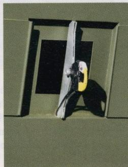
Der ausgeklappte Lasthaken des Steanook, der anstatt der »Schiebe-Schließmechanik« des Chinook eine altbewährte, modernisierte »Fensterladen-Klappmechanik« erhalten hat – jedoch ganz ohne Riegel, Haken und Ösen.
