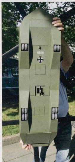
Alle Sensoren, Scheinwerfer und auch die drei Lasthaken sind verdeckt in die Zelle integriert – eine Radarerfassung sehr, sehr schwierig. Die Radpaare sind gefedert gelagert und wie beim Chinook nicht einziehbar, um auch hier viel Hydraulik, technischen Aufwand und Gewicht einzusparen.
