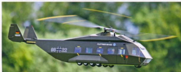
Beide Flettner des Autors machen den Lufttraum des MFC Condor Bückeburg fröhlich umherschwirrend unsicher. Mal der eine mit dem Mechanik-Kasten im Rumpf, mal der andere, weil in fünf Minuten »um-schraub-bar«. Aber beide Flettner mit völlig gleichem Flugbild. Gesteuert durch den rein mechanisch aufgebauten Mischer.
