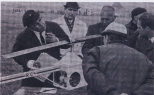
Willy Rolf aus Amelith im Solling hatte seinen vollständig aus Balsaholz aufgebauten Hubschrauber mitgebracht, der mit einer Kopfkippsteuerung versehen war. Der Punktrichter Ferdinand Paul kroch fast in das Gerät hinein, um die Getriebekonstruktion zu erfassen. Auch hier erfolgte kein Startversuch (Foto: Ferdinand Paul)
