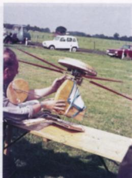
Der turbinartige Rotorkopf aus Balsaholz mit Rückdrehmoment-Antrieb sollte den Hubschrauber in die Harsewinkler Luft befördern. Dies hat bei dem Modell von Christoph Hultsch aus Weilburg an der Lahn leider nicht geklappt
