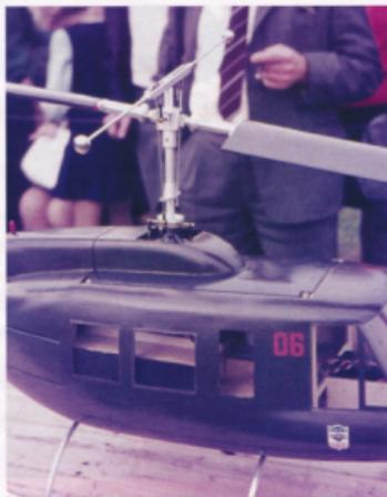
Der zweite Sieger: Aus Hameln hatte der Ingenieur F. W. Biesterfeld seine vorbildgetreue Bell UH-1D mitgebracht, die ganz aus Balsaholz aufgebaut war und über ein bemerkenswertes mechanisches Innenleben und einen funktionsfähigen Bell-Rotorhub verfügte. Antriebssystem und Steuerung waren Hubschrauber-konform. Biesterfeld führte als einziger Pilot am Sender vielbeklatschte, sekundenlange Schwebeflüge im Bodeneffekt aus
