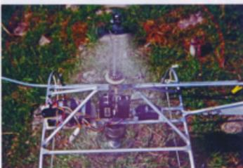
Rückdrehmoment-Rotor mit hängendem Motor, mit Seilen an vier Zelttheringe gefesselt. Tanken, Kerze anglühen und Motor anwerfen: Die Erkenntnis entgegen allen Unkenrufen von Fachleuten: Der 10-Kubikzentimeter-Motor trägt sich selbst und das ganze Gerät. Zum Fliegen reicht 's allemal (Foto: Dieter Störig)
