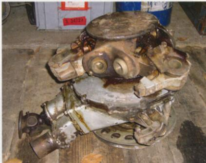
nen Rotorkopf des Drachen handeln kann, fehlen doch eindeutige Details, wie z. B. die oben liegende Spinnensteuerung der drei Rotorblätter. Dieser Rotorkopf besteht aus zwei kegelförmigen Unter- und Oberseiten, die das Getriebegehäuse bilden; abgedeckt mit einer oberen ebenen Abschlussplatte.
