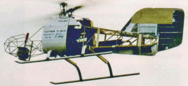
Das Sperrholzchassis von hinten. Die Rotorköpfe und Taumelscheiben stammen vom Schlüter Superior. Die obere Rudermaschine ist für die Roll-Steuerung zuständig.
