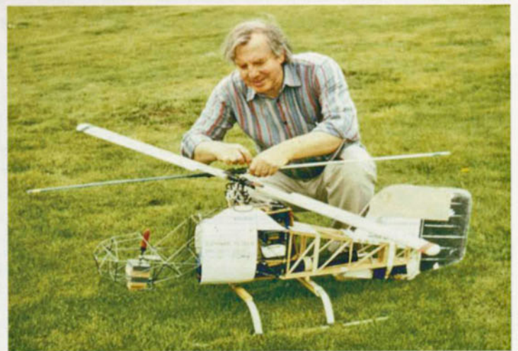
Der völlig begeisterte Pilot hat Feinjustierungen am mechanischen Mixer durchzuführen, die Schraubzwinde zu kontrollieren und nachzutanken.
